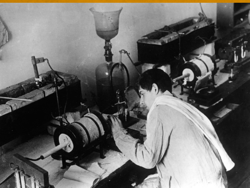
Электрические печи для определения процентного содержания углерода в стали
