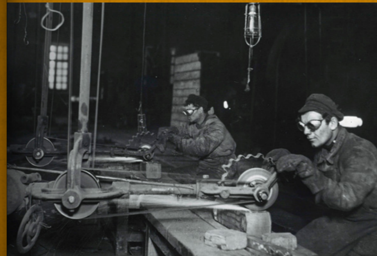
Вычитка дефектов металла на подвешных наждачных станках. Кузнечно-проктыный цех завода «Электросталь». 1923 год
