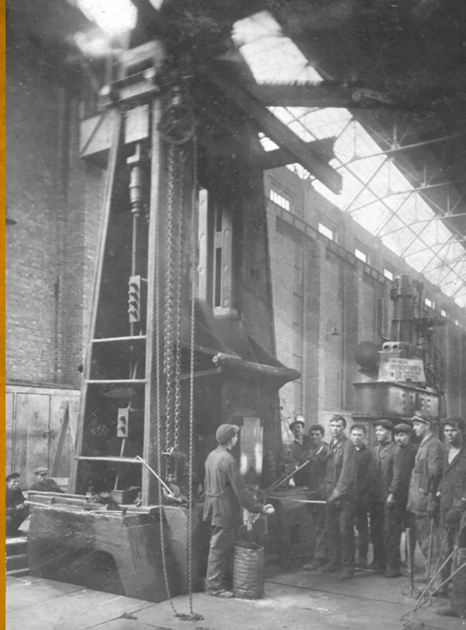
15-тонный падающий молот штамповочного цеха
